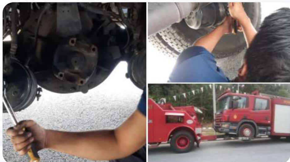
03.08.2021 : Hadir panggilan breakdown jentera Fire Rescue Tender . Pemeriksaan mendapati long shaft pada jentera tertanggal dan dibawa ke Pusat Kejuruteraan untuk tujuan pembaikan.
