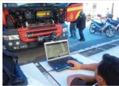
Kerja-kerja analisa kerosakan jentera dengan menggunakan 'diagnostic scan tools'. Analysis of fault machinery with diagnostic scan tools
